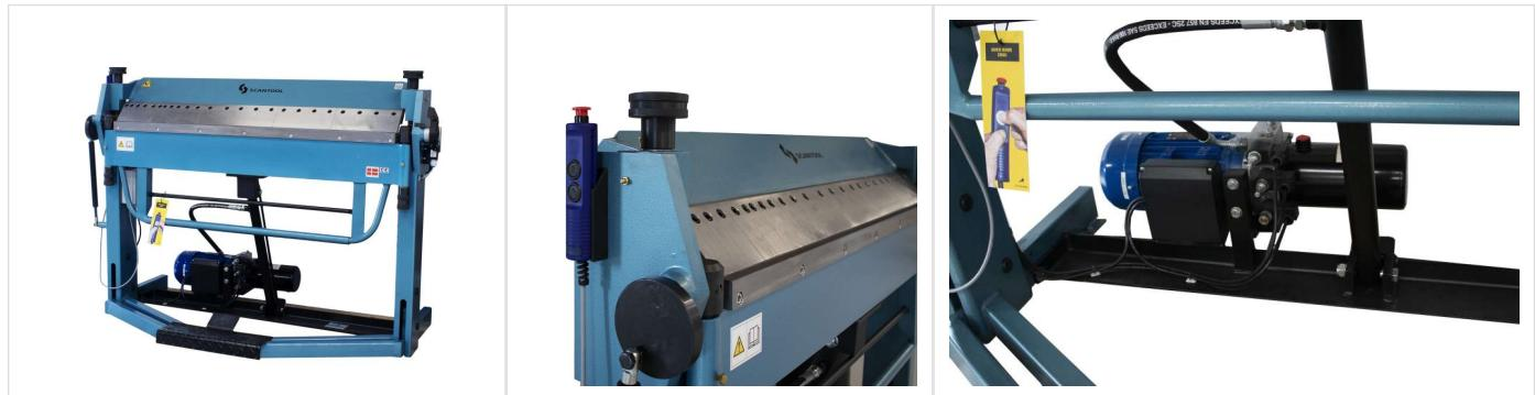
SCANTOOL SCAN 10S ERGO und SCAN 13S ERGO sind weiterentwickelte manuellen Maschinen, die mittels einen neu entwickelten und patentierten Hilfzylinder, motorisiert wurden.
