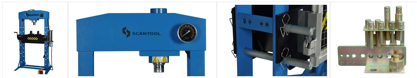
Pneumatisch/hydraulisch betriebene Werkstattpressen Modell WSP 50P.
