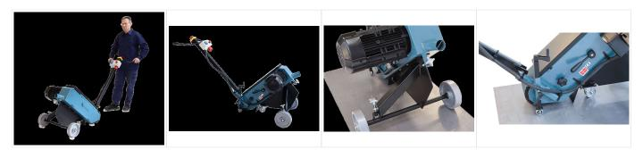
SCANTOOL 75FG Boden-Bandschleifer ist die ideale Schleifmaschine für große und schwere Gegenstände, die nicht zur Schleifstelle gehoben werden können
