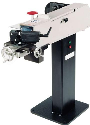
AL 100U-02, mit einer Bedienung mittels zweier Handräder und/oder eines Hebelns.
