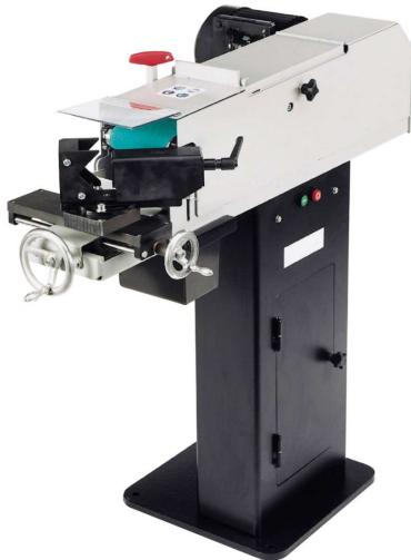
AL 150, mit einer Bedienung mittels zweier Handräder und/oder eines Hebels.
