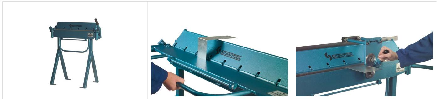
SCANTOOL SCA 700 - 1300 Schwenkbiegemaschinen sind bedienungsfreundliche Maschinen, die in Leichtbauweise, zum Biegen von Dünnblechen hergestellt sind.
