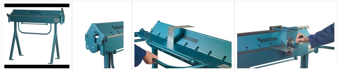
SCANTOOL SCA 700 - 1300 Schwenkbiegemaschinen sind bedienungsfreundliche Maschinen, die in Leichtbauweise, zum Biegen von Dünnblechen hergestellt sind.
