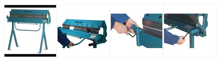
SCANTOOL SCST 700 - 1300 manuellen Schwenkbiegemaschinen sind bedienungsfreundliche Maschinen, die in Leichtbauweise, zum Biegen von Dünnblechen hergestellt sind.
