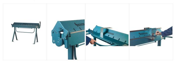
SCANTOOL SCA 700 - 1300 Schwenkbiegemaschinen sind bedienungsfreundliche Maschinen, die in Leichtbauweise, zum Biegen von Dünnblechen hergestellt sind.
