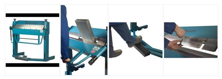
SCANTOOL SCAN 10S ist manuelle fußbedienbare Maschinen, wo die Oberwange das Biegeobjekt festhält.
