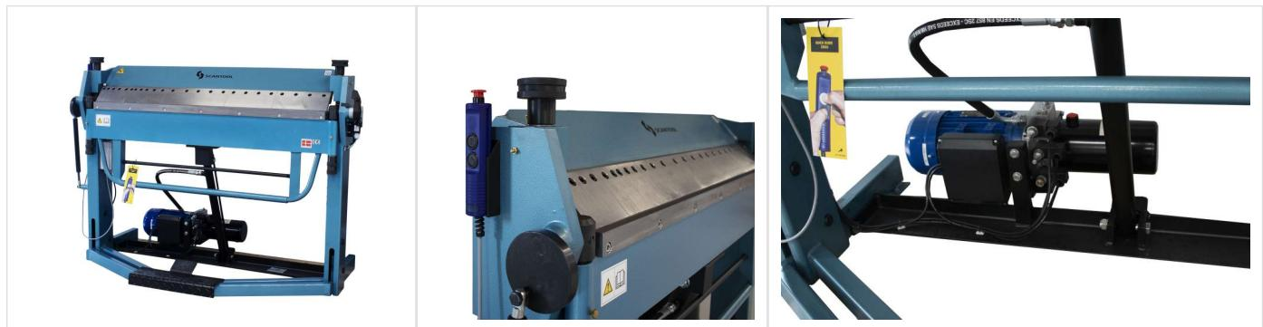
Les plieuses SCANTOOL SCAN 10S & 13S sont des plieuses motorisées, développé et brevetées, très efficaces avec un système de vérin pour support pliable.
