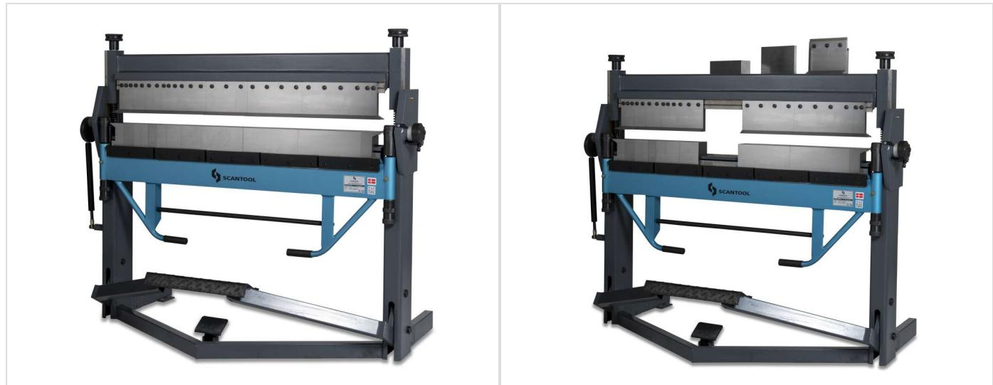
SCANTOOL SCAN 10S & 13S FLEX sont des plieuses avec segments répartis selon des pinces, des outils, etc. pour le pliage de matériaux dans le sens inverse permettant la création de profils spéciaux.
