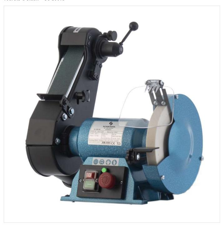
Touret d'établi pour ponçage et polissage destiné à l'industrie. SC 200TB (3x400V) avec meule grossière NK et bras de courroie.
