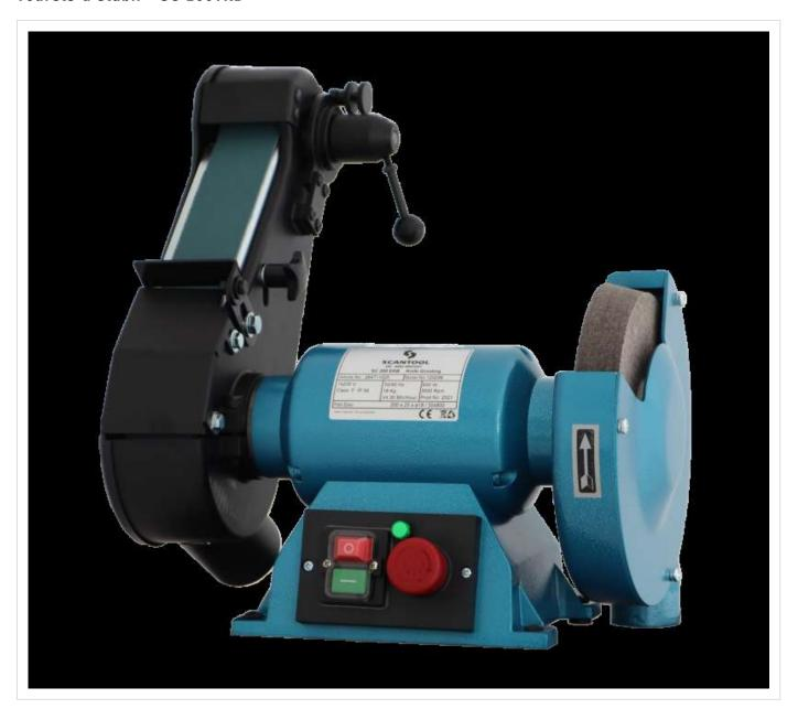
SC 200TKB (3x400V) avec bras de courroie (50x800mm) et disque en feutre.
