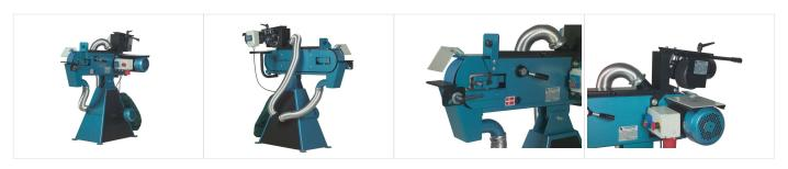
Les ponceuses à bande centerless et de polissage Scantool 75 CGX sont fournies avec un accessoire s'intégrant celles-ci avec une bande de 75x2000 mm et une grande surface de ponçage.
