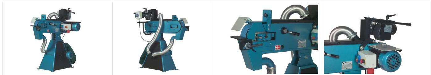
Les ponceuses à bande centerless et de polissage Scantool 75 CGX sont fournies avec un accessoire s'intégrant celles-ci avec une bande de 75x2000 mm et une grande surface de ponçage.
