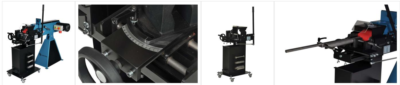
Scantool 75RB est, d'abord et avant tout, des ponceuses à bande pour tuyaux de tous types (rond, carré, solide) et avec des diamètres entre 17 mm et 100 mm.
