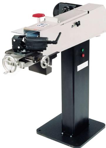
L'AL 100U-02 est équipé d'un système de chariot à deux manivelles (convertible).
