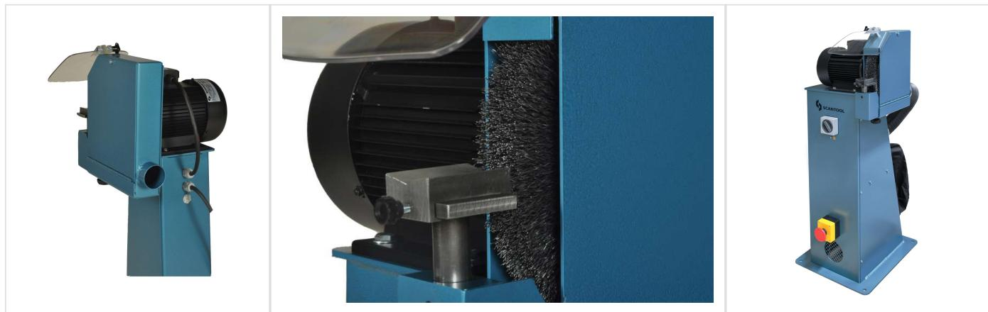
La machine d'ébavurage SCANTOOL 250 AGS est construite une base solide et dispose d'un puissant moteur de 3,0 HP permettant de traiter des projets importants d'ébavurage et d'extraction avec un sac à poussière.
