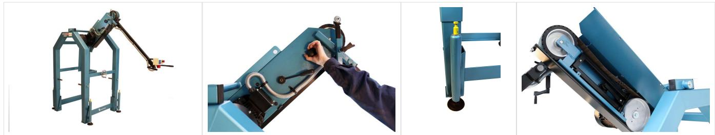
Le modèle 75PG a été développé en étroite collaboration avec l'industrie offshore afin de répondre aux besoins des utilisateurs finaux en matière de meulage de cordons de soudure sur de gros tubes.
