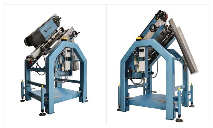
**ROCKET 75** a été développée en étroite collaboration avec l'industrie offshore afin de répondre aux exigences des utilisateurs finaux pour le meulage des cordons de soudure sur de grands tuyaux tels que les tours d'éoliennes, les réservoirs, les silos, etc
