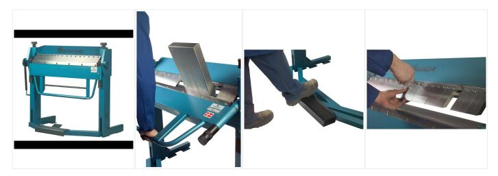
SCANTOOL SCAN 10S est conçus avec un serrage au pied du porte-à-faux, ce qui permet d'obtenir un processus de travail particulièrement simple et rapide, car les deux mains sont libres pour ajuster le matériau de pliage.
